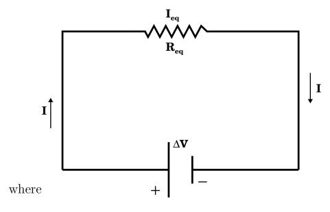
$$\begin{split} \Delta V &= I_{\rm eq} R_{\rm eq} = I R_{\rm eq} \\ \Delta V &= \Delta V_1 + \Delta V_2 = I_1 R_1 + I_2 R_2 = I R_1 + I R_2 \\ I R_{\rm eq} &= I R_1 + I R_2 \; . \end{split}$$
